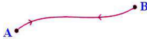
Fig.1.6. Principe du retour inverse de la lumière
