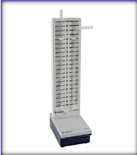
Fig.2.14. Manomètre à eau
