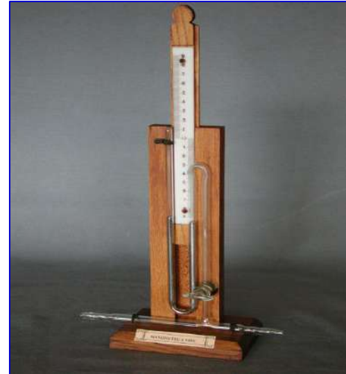
Fig.2.15. Manomètre à mercure
